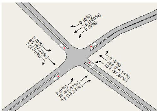
Les débits sont analysés au niveau des sections et nœuds d'un réseau. L'indicateur des débits en UVP au niveau est représenté sur la droite. Cette visualisation est un outil d'Aimsun, le script permet de choisir d'exprimer les résultats en UVP.
